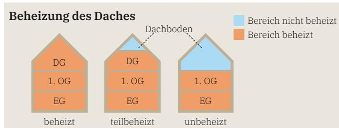
Teilbeheizte Dächer besitzen über dem beheizten Dachgeschoss zum Beispiel einen unbeheizten Dachboden, Speicherkammer oder ähnliches.
