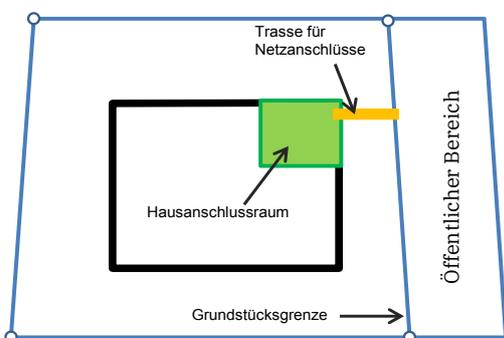
Die Skizze zeigt beispielhaft die Anordnung von Netzanschlüssen und deren ungefähren Platzbedarf in einem Anschlussraum gemäß DIN 18 012. Sollte zur Wanddurchdringung eine Mehrsparten-Haus-Einführung (MSHE) gewünscht werden, so informieren Sie uns bitte frühzeitig unter 0208 4501 240
