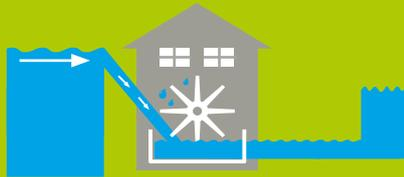
Fließendes Wasser wird gestaut. Große Durchflussmengen erbringen hohe Leistung. Diese Kraftwerke liefern zuverlässig und werden zur Grundlast-Stromversorgung eingesetzt.
